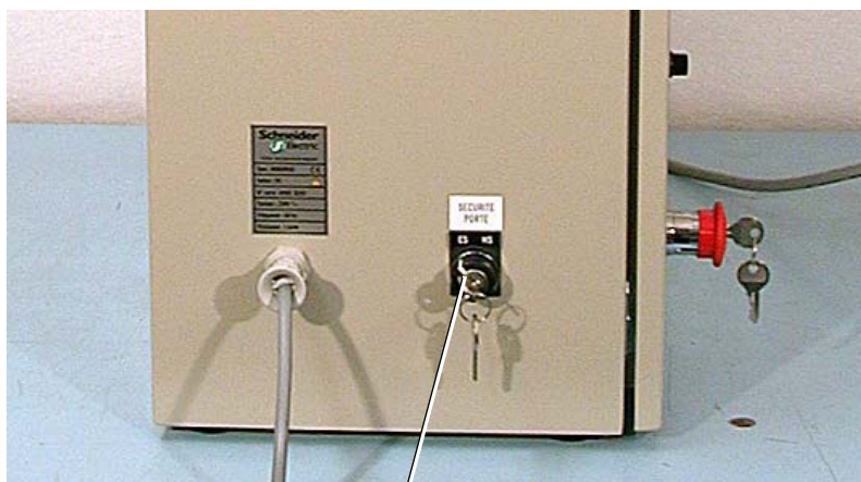
Commutateur à clé "Sécurité porte" sur position HS
